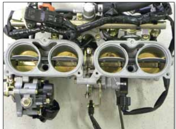
Système de double papillon Yamaha
