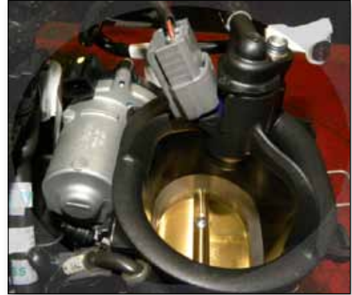
Exemple d'un papillon motorisé du cylindre avant d'une Panigale DUCATI.
