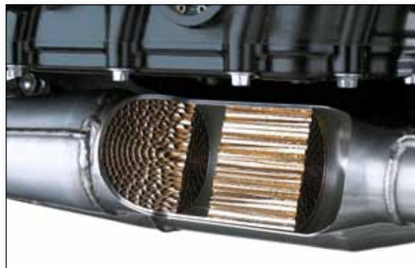
Coupe d'un catalyseur de ZX1000 Kawasaki
