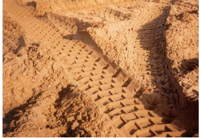
b) Sable sec assez compacté, la hauteur d'ornière est faible. Les empreintes des sculptures sont nettes et bien formées. Le déboufrage est parfait. Il n'y a pas de problèmes de motricité.
