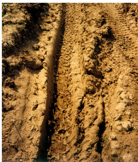
e) Ornière en terrain argileux à teneur en eau moyenne. L'ornière peut se former, mais elle n'est pas profonde. La cohésion horizontale est limitée, car elle montre des zones de cisaillement de l'empreinte.
