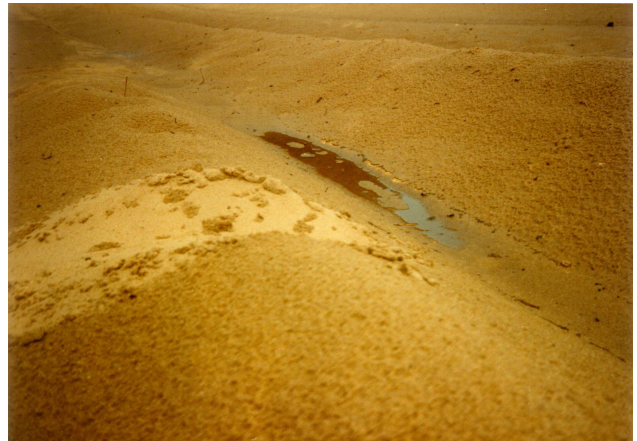
d) L'ornière précédente après forte pluie de quelques minutes. En fond de sillon, l'eau tarde à pénétrer dans le sol et sur la couche superficielle, l'eau a formé une croûte qui n'est pas suffisamment résistante pour permettre la motricité. Une fois cette croûte enlevée, le sable sec apparaîtrait. La pluie n'aura pas sensiblement amélioré la cohésion du sable, ni la motricité.
