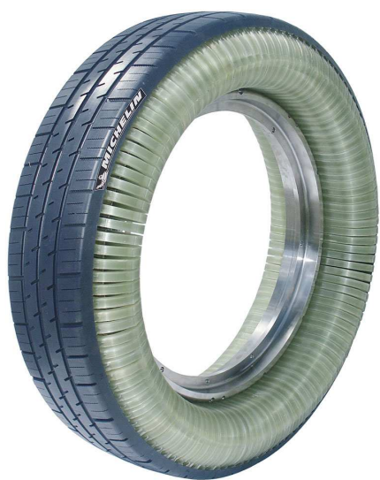
Fig. 1.10 Pneumatique MICHELIN, sans air, incluant la jante et à bande de roulement amovible.
