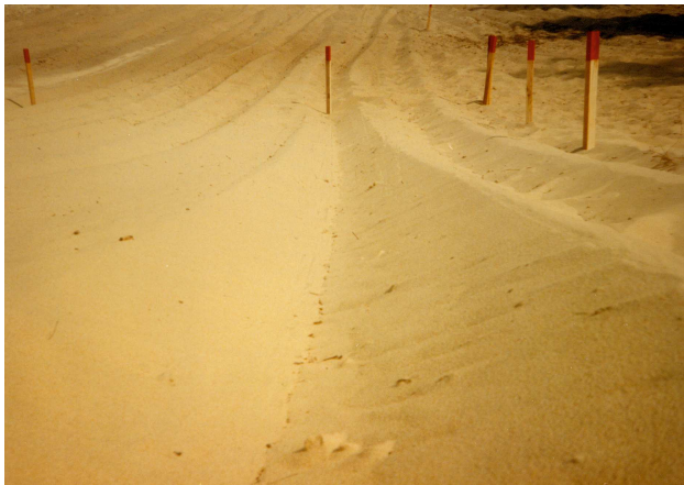
c) Forme d'ornière dans un sable sec sans cohésion. L'ornière forme un V.
