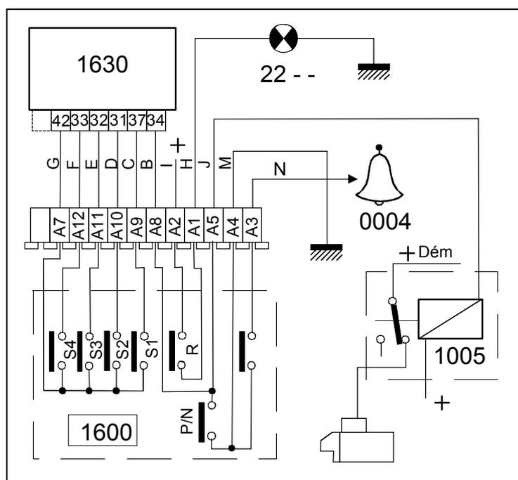
Le contacteur «multifonction» est entraîné par le levier de vitesses.
