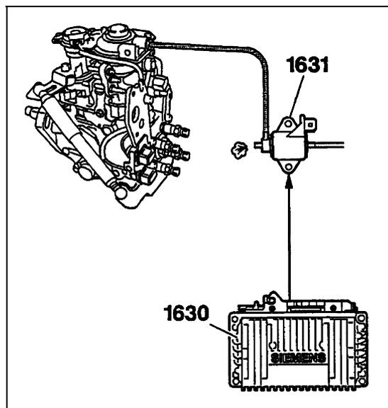
L'estompage de couple est réalisé par une réduction du débit de gazole.
