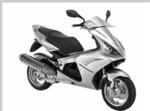
Peugeot : JET FORCE 50 cm 3 TDSI (monocylindre deux temps à injection directe)
