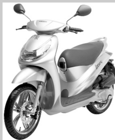
Peugeot : Looxor 50 cm 3 TDSI (monocylindre deux temps à injection directe)
