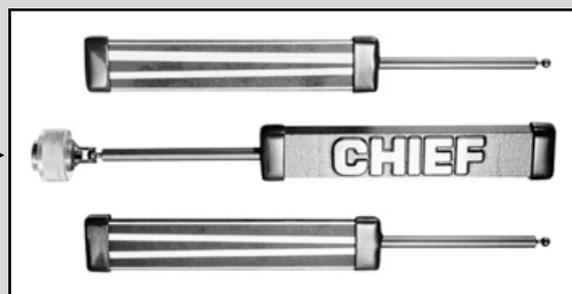
Le scanner peut se placer n'importe où sous le véhicule, pourvu que les faisceaux lumineux atteignent les cibles. Le cycle de mesure se répète toutes les trois secondes.
