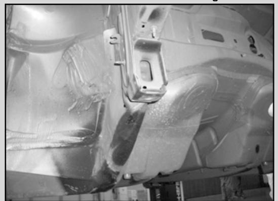
Fig. 2 : Trous pilotes droits sous le plancher d'une Peugeot 307
