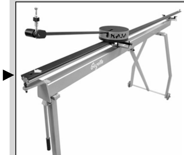
Le bras de mesure correspond au PC par radio. En approchant le probe (capteur) du point à contrôler, un signal est émis qui indique le bon choix du point à mesurer.
