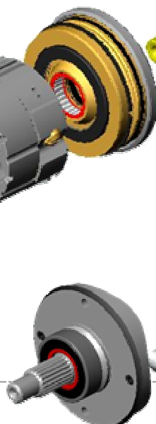
Détail du rotor de coupleur
