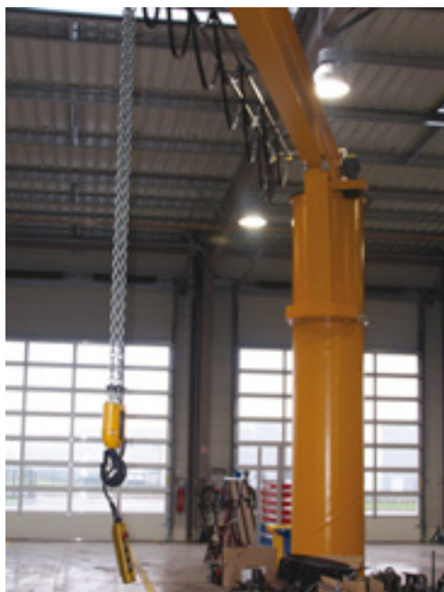
Potence avec rotation à 360 °C avec treuil pour couvrir deux travées
