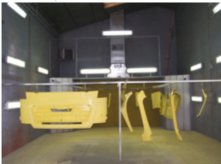
Cabine à aspiration frontale pour la mise en peinture de pièces diverses qui sont suspendues à un carrousel de manutention.
