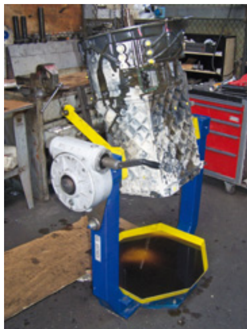
Appareil de manutention de boîte de vitesses avec système de récupération d'huile
