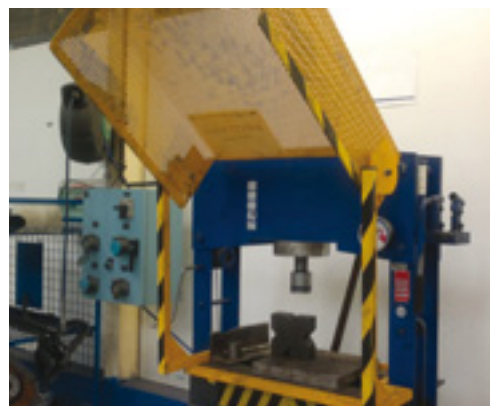
Presse hydraulique pour redresser, emmancher, remonter les roulements, etc.
