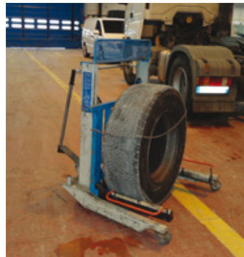
Appareil facilitant la dépose et la manutention des roues dans l'atelier
