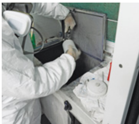
Poste de nettoyage des pistolets de pulvérisation de peinture hydrodiluable
