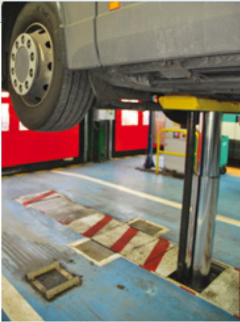
Pont à fût (la traverse baissée ne crée pas de butée au sol)
