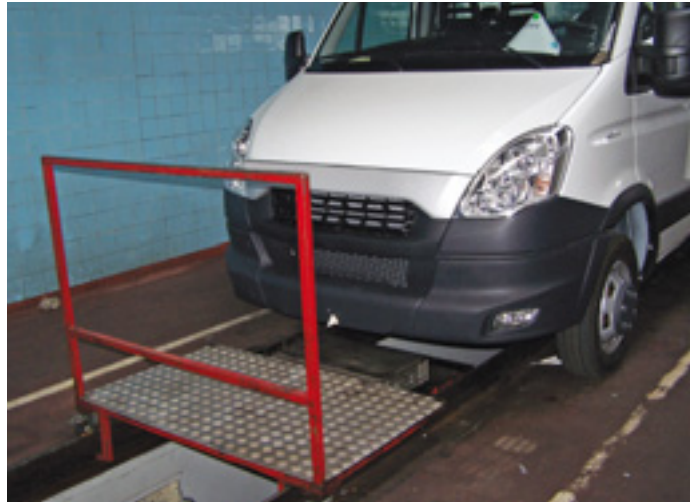
Chariot de vidange avec plate-forme de travail circulant sur rails de guidage latéraux
