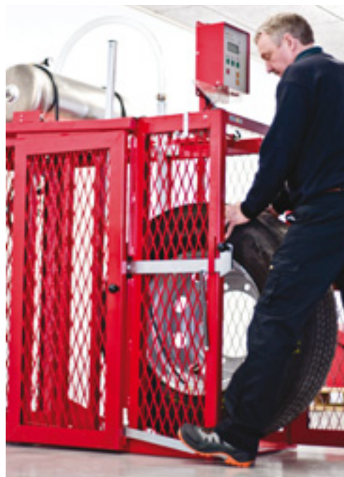
Cage anti-souffle pour le gonflage des pneumatiques. La cage est avec double paroi à mailles décalées afin, en plus de protéger des projections de matière, de « casser » le souffle projeté par un pneumatique qui explose.
