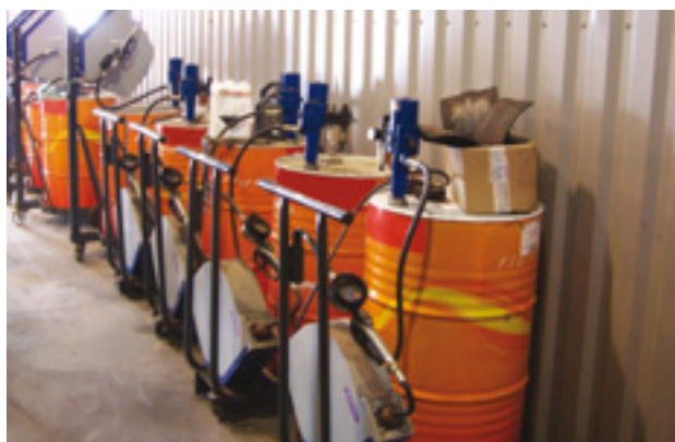
Fûts sur supports roulants et munis de cannes pneumatiques de graissage
