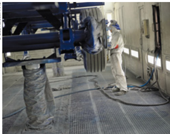
Tunnel de mise en peinture à ventilation verticale.
