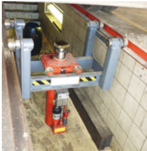
Vérin de fosse sur rails de guidage avec déplacement longitudinal sur la fosse et transversal sur le support vérin
