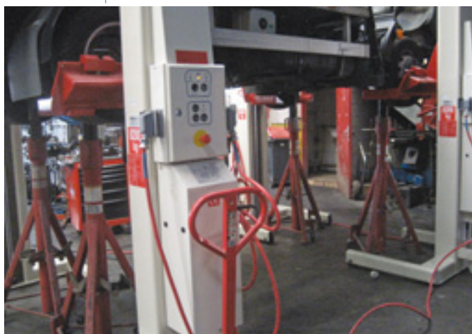
Véhicule levé à l'aide de colonnes mobiles et reposant sur des chandelles
