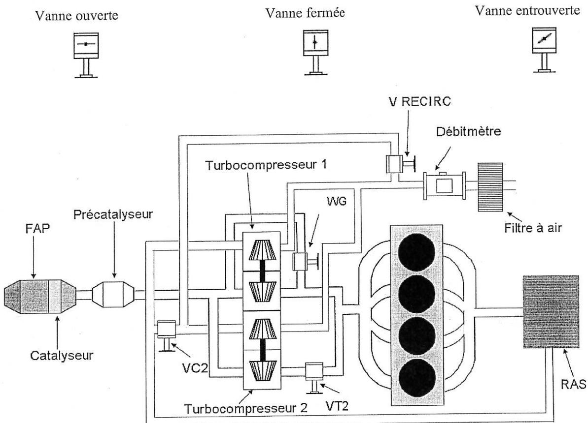
1.3.2 - Expliquez le fonctionnement du système dans cette phase et indiquez la plage de régime où le système fonctionne en mode mono turbocompresseur.
