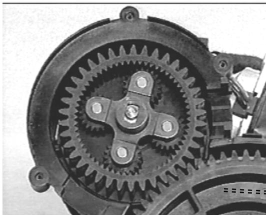
Les satellites (13) sont maintenus par un porte satellite solidaire de la roue dentée (16).
