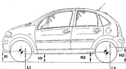
H1 : distance entre la zone de mesure sous berceau avant et le sol
