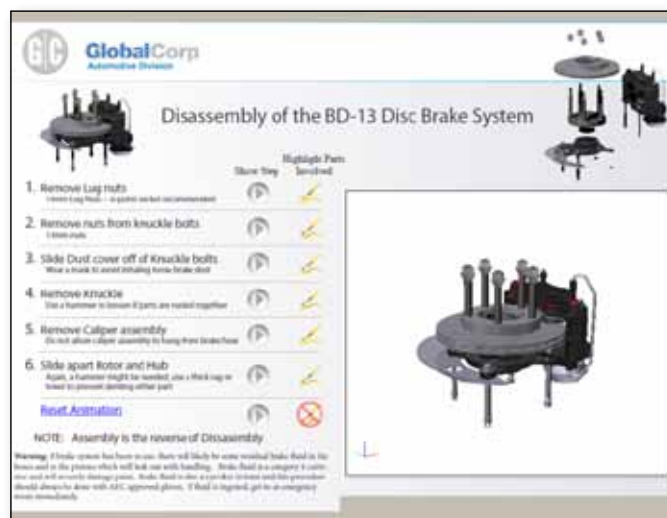
Fig. 0.5. Démontage du frein à disque BD-13 (document Pdf3d animé)
