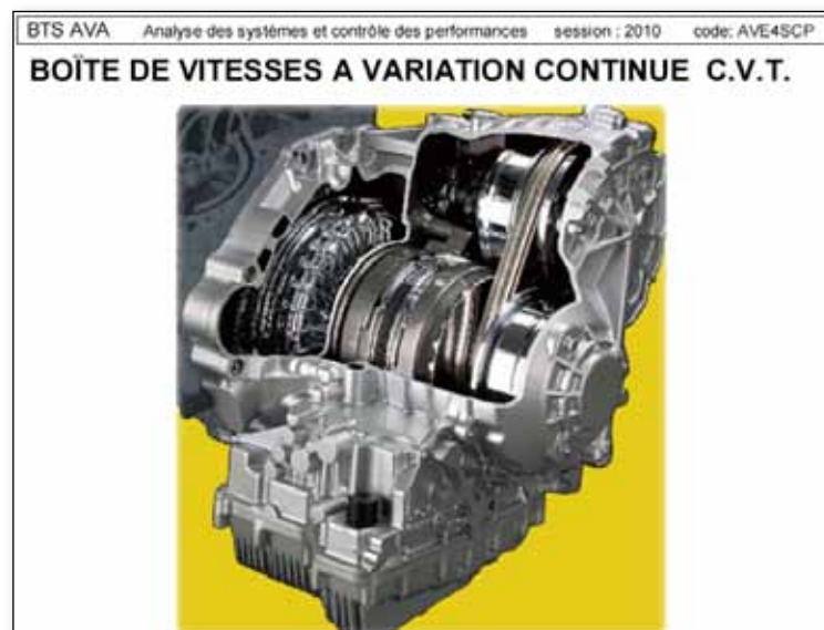
Fig. 0.1. L'outil CAO 3D ou modeleur volumique (boîte de vitesses à variation continue)
